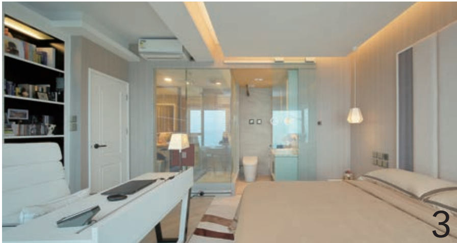
毗連的套廁及客廁均改作玻璃間隔，提升通透度，玻璃可按需要霧化。
